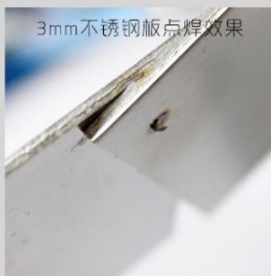
2mm不锈钢板点焊效果
