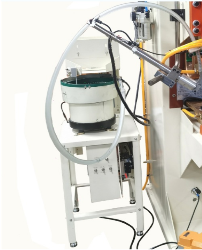
螺母自 送料点 机技 参数Technical parameters of nut automatic feeding spot welder
